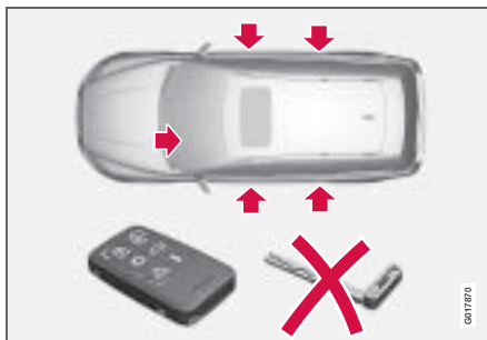
Zamki otwierane i zamykane zdalnie, gdy zostanie uruchomiona blokada serwisowa
