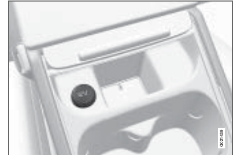
Gniazdo 12 V w konsoli pomiędzy fotelami
