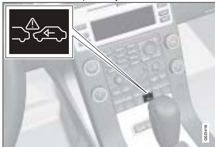
Wyłącznik sygnalizacji ostrzegawczej
