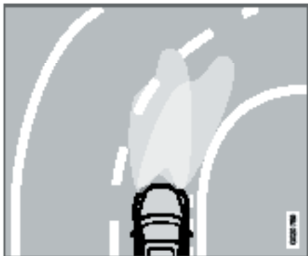
Snop światła reflektorów. Po lewej funkcja ABL wyłączona, po prawej funkcja ABL aktywna.
