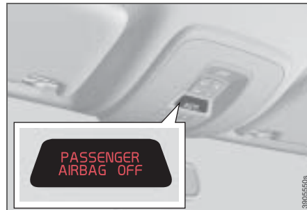
Sygnalizacja wyłączenia czołowej poduszki powietrznej po stronie pasażera
