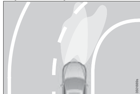
Kształt wiązki światel mijania przy wyłączonej (lewa) i włączonej (prawa) funkcji doświetlania zakrętu
