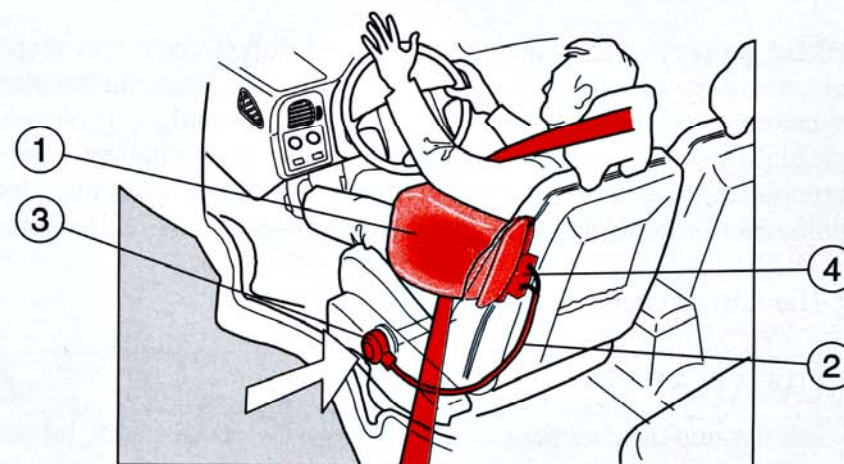
1. Boczna poduszka gazowa 2. Przewód pirotechniczny
