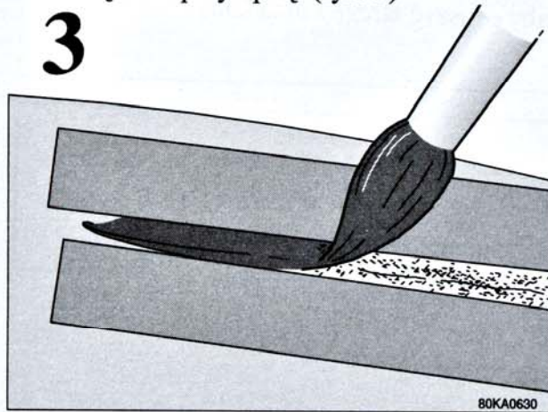
Ograniczanie miejsca naprawy taśmą
