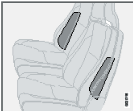
Miejsce zamontowania bocznych poduszek powietrznych.
