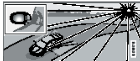
Promień słońca znajdującego się nisko nad horyzontem padające na obiektyw kamery.
