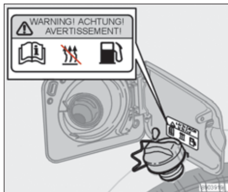
Etykieta ostrzegawcza na pokrywie wlewu paliwa.
