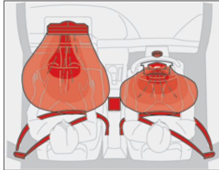
Czołowe poduszki powietrzne w wersji z kierownicą po prawej stronie.
